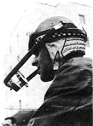
L'«occhio di Polifemo» del genovese Costa: un ingegnoso snodo di due bracci assicurati al casco per reggere il cronometro con annessa lente per facilitarne la lettura.
